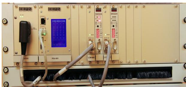
Erfassungseinheit (84TE) mit zwei Doppeldetektoren
