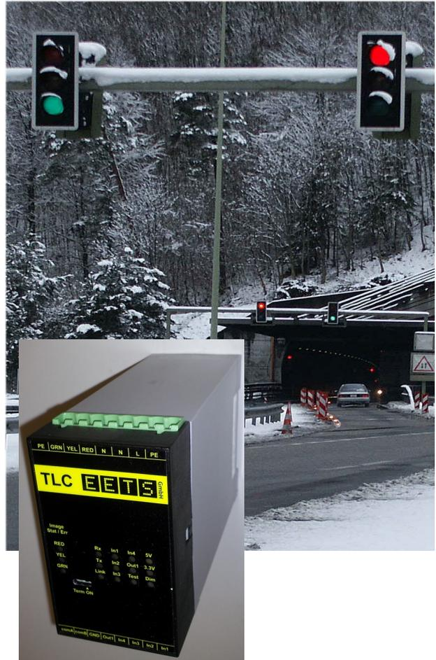
erkennt, ob ein LED-Einsatz vorhanden ist, ein Kabelunterbruch vorliegt oder ein LED-Einsatz defekt ist.
