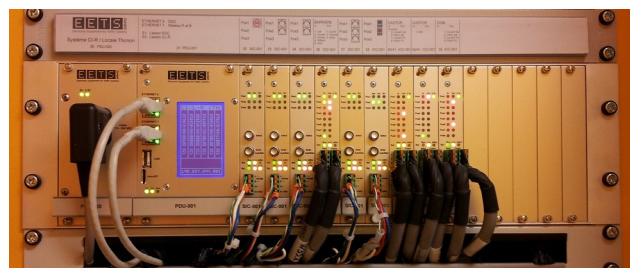
Systemeinheit (84TE), bestückt mit 5 Signal- und 4 I/O-Karten
